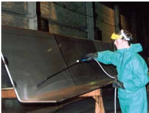
Passivace dílu, který bude součástí objemného chemického tankeru z oboustranné nerezové oceli
